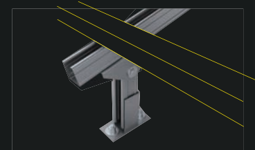
导轨固定安装
